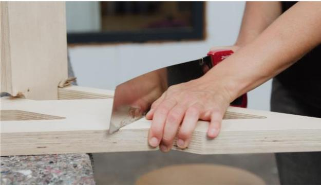
Sägen Sie beide Wangenelemente an der angezeichneten Schnittkante ab. Nutzen Sie hierfür eine Japansäge oder Handkreissäge. Sollte die Spreizmuffe an der Schnittkante liegen, ziehen Sie die Muffe vor dem Sägen aus dem Bohrloch.
