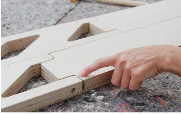
Das Spaltmaß zwischen der Stufe und den Wangengabeln sollte immer ca. 1,5mm betragen damit die Achse im nächsten Schritt eingeführt werden kann. Sollten Sie die Stufe zu tief in die Wange geschoben haben, ziehen Sie die Stufe wieder ein wenig heraus, bis das Spaltmaß ca. 1,5mm beträgt.
