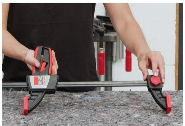
Durch das Umpositionieren des Oberteils, kann die Zwinde auch auf Spreizen umgestellt werden. Hierzu lösen Sie die Verriegelung und stecken das Oberteil auf der anderen Seite der Schiene so auf, dass die Backen in entgegengesetzte Richtungen zeigen.
