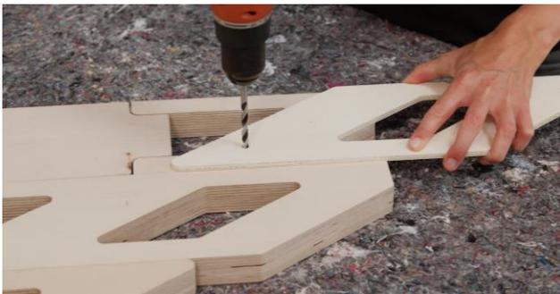
Nun werden die Durchgangslöcher für die Wandinstallation vorgebohrt. Legen Sie sich hierfür ein Stück Holz o.Ä. unter die Bohrstelle, setzen Sie den Bohrer in dem vorgebohrten Loch des Distanzstücks an und bohren Sie durch die Wange (6mm Bohrer).
