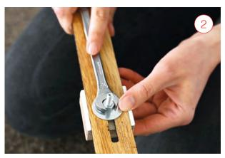
② Ziehe die Schraube anschließend so fest, dass sich das Multiplexklötzchen während dem Aufbau der Treppe nicht mehr verschieben kann.
